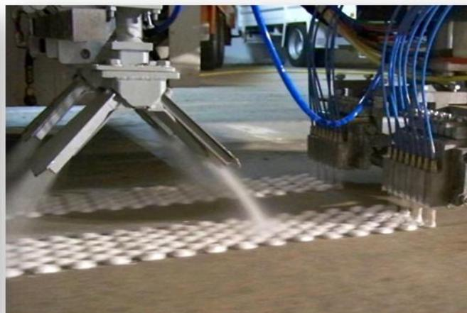
4. Pompe à commande hydraulique, ajustage électronique du débit.
