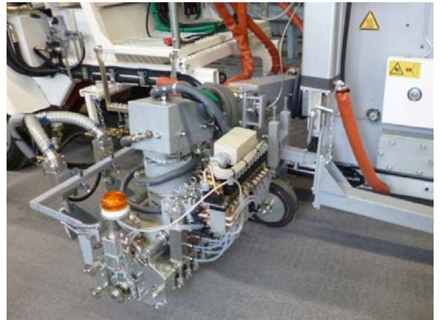
Cabezal extrusor giratorio
