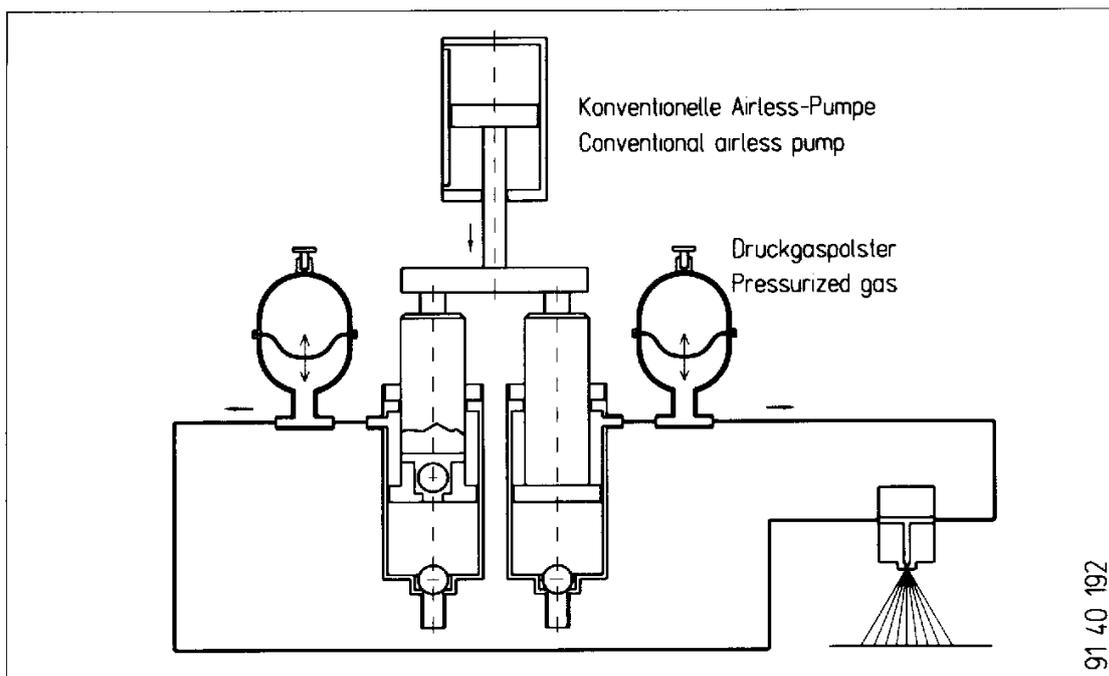
Die Kapazität eines der beiden Pulsationsdämpfer kann leicht überschritten werden, wenn die betreffende der beiden Stammkomponenten eine deutlich höhere Viskosität aufweist als die andere, was in der Praxis immer wieder vorkommt (z.B. bei der vorgemischten Komponente infolge einer fortschreitenden langsamen Reaktion).
