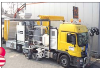
H75-3000EX mit Kochern (2 x 1100 ltr) sowie Druckbehälter (800 ltr) für spritzbare Thermoplastiken. Sprayplastik-Markeureinheit sowie Multi-DotLine® Extruder beidseitig. Selbstbeladung durch einen aufgebauten Kran
