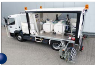
H36-1300P mit Druckbehältern (2 x 650 ltr) für Kaltfarben für Airless-Spritzverfahren, 90 cm Breitstrichmarkeur mit 4 Farb- und Perlpistolen
