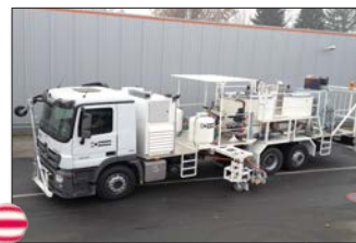
H75-3400P mit drucklosen Behältern (2 x 1700 ltr) für spritzbare Thermoplastiken mit Schneckenpumpe, Markeureinheit beidseitig
