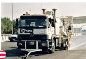
H75-2500P mit drucklosem Behälter (2500 ltr) für spritzbare Thermoplastiken mit wegabhängiger Dosierpumpe (AMAKOS®)
