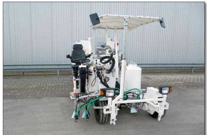
A Sistema para la aplicación de materiales en proporción a la velocidad de marcha (AMAKOS®), aplicable bajo determinadas condiciones: Espesores de capa constantes independiente de la velocidad de marcha o por ajuste manual son posibles. (Véase información n° 396)
