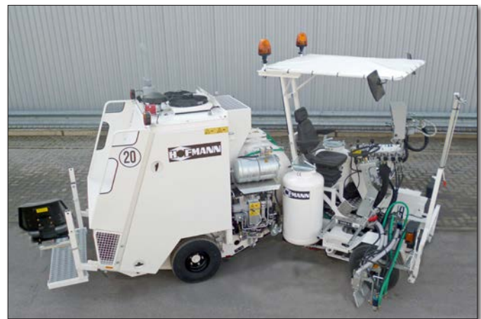
☞ Schmale und extrem wendige Maschine mit nach rechts verschieb- baren Bedienungsstand, dadurch ...
