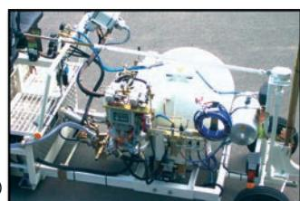
Kompaktní, úzký a dobře ovladatelný značkovací stroj určený pro střední objemy prací.
