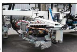
② H18-1 značkovací stroj pro aplikaci termoplastů, se zařízením MultiDotLine univerzální extruder, systém Kamflex, zásobník o objemu 300 l
