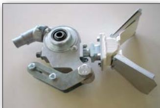
двойной дозирующий пистолет для стеклошариков
