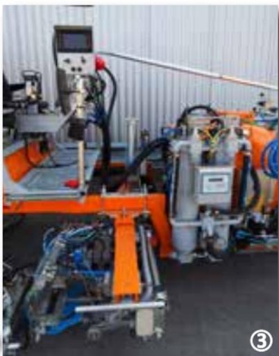
Способ дозирования: сифонный насос основного компонента 98 %, а также плунжерный насос отвердителя 2 % для 2-х компонентных хол. пластиков с MALCON4E
