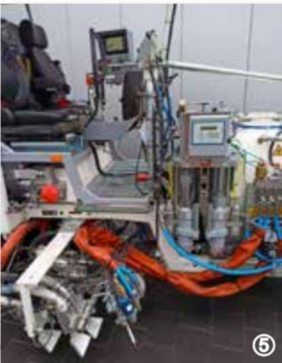
Дозировка: плунжерный насос для 98% основного компонента и 2% отвердителя для холодных двухкомпонентных пластиков воздушным способом (низкое давление) с компьютером MALCON 4E
