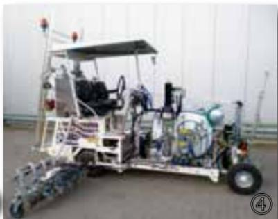
④ H18 в Сингапуре с вакуумной системой для 1К-холодных красок для работы широкополосного маркировщика 120 см с 5 пистолетами для краски и стеклошариков и напорным баком 460 л оснащенный как система паллетирования с электрическими и гидравлическими быстрыми затворами, а также накладками для быстрой смены используемых узлов с помощью вилочного погрузчика.
