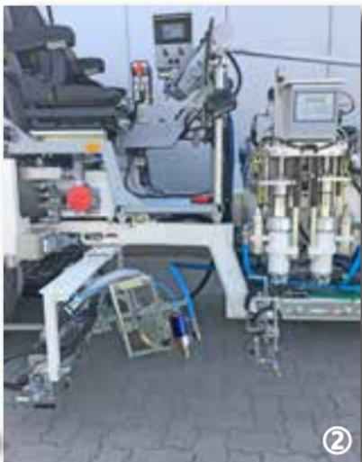
Способ дозирования: плунжерный насос безвоздушного распыления для хол. красок с MALCON4E
