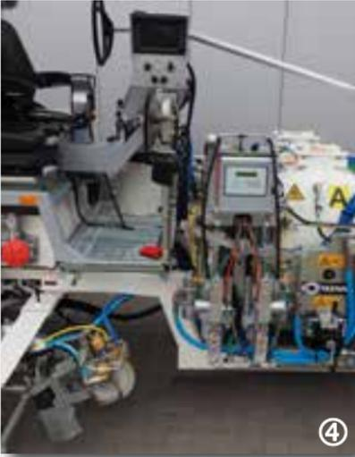
Дозировка: плунжерный насос для 98% основного компонента и 2% отвердителя для холодных двухкомпонентных пластиков безвоздушным способом (высокое давление) с компьютером MALCON 4E
