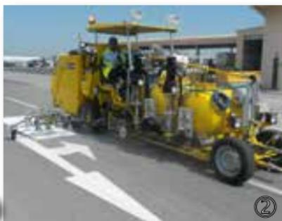
② H33 в Манаме (Бахрейн) с безвоздушной системой для 1-компонентных холодных красок, 1 x 460 л и 2 x 220 л бака под давлением для использования на маркировщике шириной 90 см, с 4 пистолетами для краски и стеклошариков, а также дополнительными 3 пистолетами для краски и стеклошариков для рулевых дорожек (черного/желтого/черного цвета).
