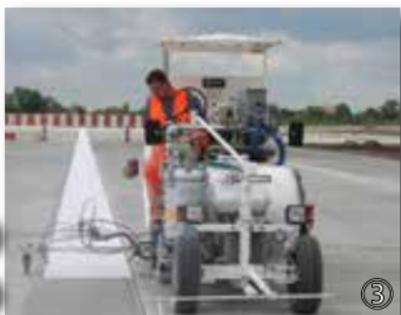
③ H26 в зоне для самолетов Airbus в Гамбурге (Германия). Установка снабжена 1-компонентной вакуумной системой, а также 2-компонентной вакуумной системой для распыления «холодного пластика» M98:2, контейнером 460 л под давлением и включающим 3 распылителя краски, для нанесения линий шириной 90 см.
