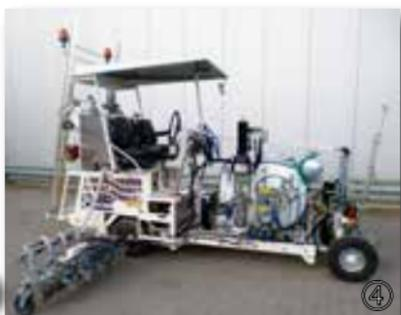
④ H18 Singapoure équipée pour peinture à froid de mono-composant Airless, avec marqueur aéroportuaire de 120 cm et avec 5 pistolets de peinture et billes de verre, réservoir sous pression de 460 l.
