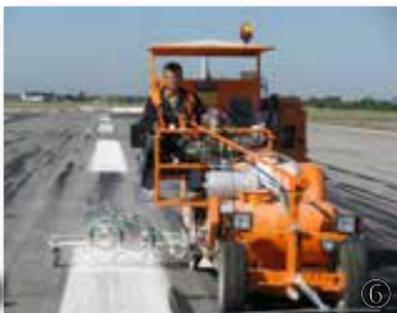
⑦ H33 à Hambourg / Allemagne avec système pour peinture à froid de 1-composant Airless avec 5 pompes de Airless, 1 x 460 l et 2 x 220 l ainsi que 2 x 110 l réservoirs sous pression et avec marqueur aéroportuaire 90 cm avec 4 pistolets de peinture ainsi que avec 12 pistolets de peinture additionnels pour des couleurs: blanc, rouge, bleu, jaune et noir, pour des «taxiways» et lignes de sécurité.
