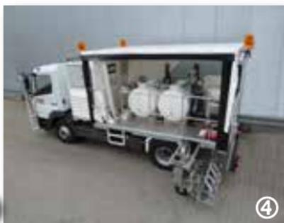
③ H37-5000P camion de marquage à usages multiples avec des réservoirs sans pression échangeables (4 x 1250 l) pour peintures à froid 1-composants avec pompe et pour l'enduits à froid 2-composants pulvérisés pour procédé Airless avec pompe de dosage dépendant de la vitesse AMAKOS®.
