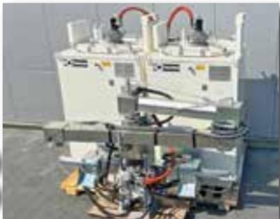
**Le système de transfert de produit utilise une vis pour transporter un produit de marquage abrasif et très visqueux. Il est utilisé dans le transport de l'enduits à chaud en couche épaisse ainsi que de l'enduits à chaud pulvérisés afin d'atteindre un taux de transfert élevé dans les plus brefs délais.**
