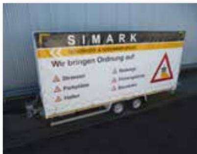
**Remolque de transporte de dos ejes, especialmente indicado para el transporte de máquinas de marcaje más grandes, p. ej., una H33 o una H26.**
