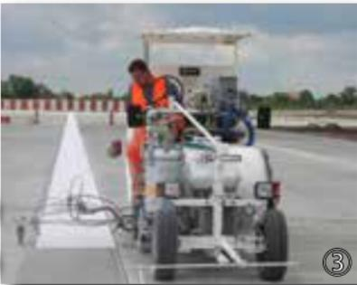
③ H26 en el terreno de la compañía Airbus, Hamburgo / Alemania equipada con sistema de pinturas en frío de 1-componente Airless así como pinturas plásticas en frío pulverizables de 2-componentes Airless M98:2, 460 l depósito presurizado así como marcador aeroportuario de 90 cm y 3 pistolas de pintura.
