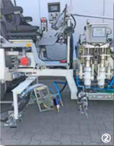
Procedimiento de dosificación: Bomba de émbolo para pinturas en frío Airless con MALCON4E
