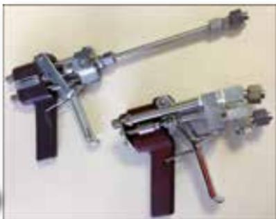
**Pistola pulverizadora manual Airless para 2-comp. M98:2 y M1:1**
