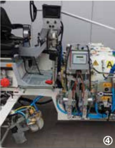
Procedimiento de dosificación: Bomba de émbolo para el componente de base de 98% y para componente endurecedor de 2%, para pinturas plásticas en frío 2c pulverizables Airless (procedimiento de alta presión) con MALCON4E
