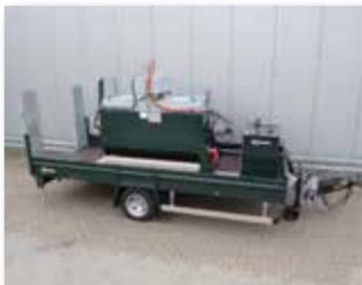
**Remolque de transporte de un eje con neumáticos gemelos, para el transporte de máquinas de tamaño mediano, p. ej., una H18, RM3D, H17 o una caldera.**
