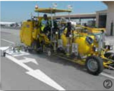
② H33 en Manama/Baréin con sistema de pinturas en frío de 1-componente Airless, 1 x 460 l y 2 x 220 l depósitos presurizados, con marcador aeroportuario de 90 cm, con 4 pistolas de pintura y de esferas así como con 3 pistolas de pintura y esferas adicionales para taxiways (negro/amarillo/negro)
