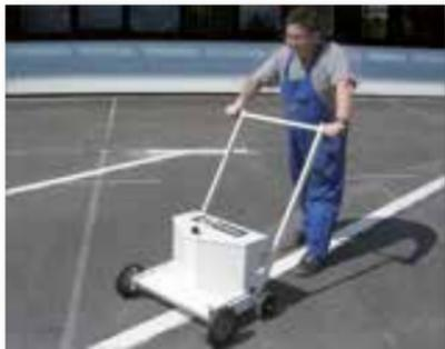
El dispensador de esferas de rodillos, conducida a mano, es adecuada allí donde la aplicación de esferas a máquina no es posible, y la aplicación manual no es rentable o no está permitida.
