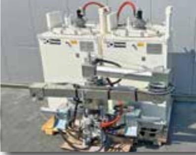
Das Materialtransfersystem fördert über eine Schnecke abrasives und hochviskoses (stark zähflüssiges) Markierungsmaterial. Anwendung findet es bei der Förderung von dickschichtigen Thermoplastiken sowie spritzbaren Thermoplastiken, um in kürzester Zeit eine hohe Transferleistung zu erreichen.
