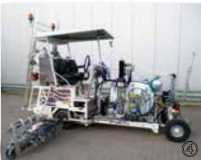
④ H18 in Singapur mit 1K Kaltfarben Airless System mit 460 ltr Druckbehälter für den Einsatz mit 120 cm Breits-trichmarkeur mit 5 Farb- und Perlpistolen.
