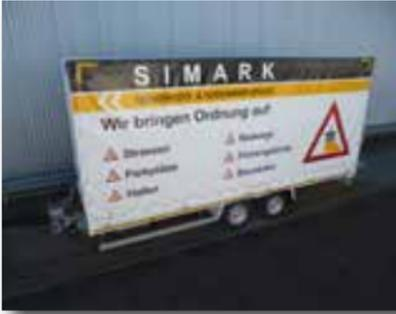
**Der zweiachsige Transportanhänger eignet sich für den Transport größerer Markiermaschinen, z.B. einer H33 oder einer H26.**
