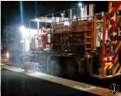
① H75-3000P in Rom/Italien mit spritzbarem Thermoplastik System mit Dosierpumpe für den Einsatz mit 90 cm Breitstrichmarkeur mit 4 Sprayplastikpistolen und 4 Perlpistolen, 2 x 1500 ltr drucklose Behälter.
