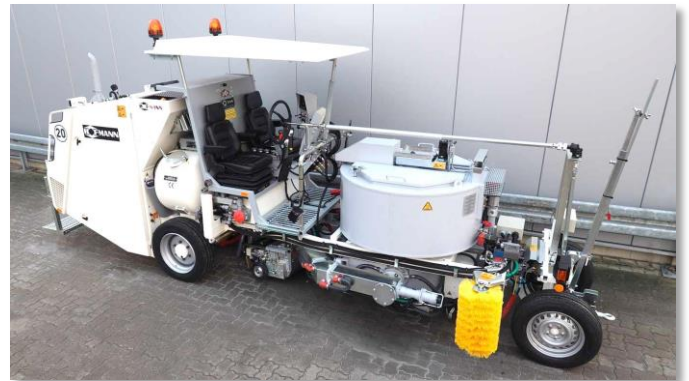
Position de transport: Extrudeuse pivotante sous le réservoir
