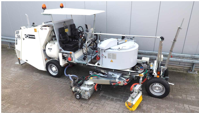
Position de marquage: Extrudeuse pivotante sur le côté du réservoir
