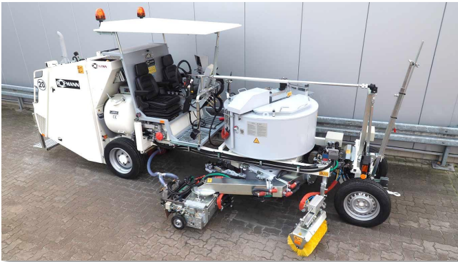
Markierstellung: Extruder seitlich neben dem Behälter
