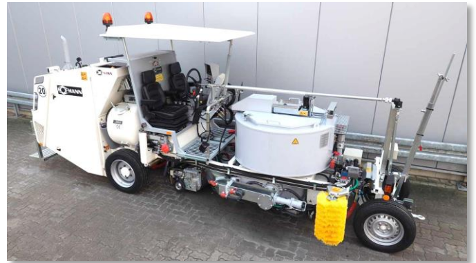
Transportstellung: Extruder unter dem Behälter
