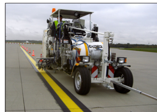
H36-800P in Hong Kong/China cu sistem de aplicare airless mono-component cu marcator aeroportuar 90 cm latime de lucru compus din 4 pistoale de vopsea si microbule, rezervoare presurizate 1 x 385 l si 2 x 220 l (diviate)
