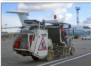
H26 in Saint Petersburg/Russia cu sistem de aplicare airspray mono-component precum si sistem aplicare Airless bi-component 98:2, cu rezervor presurizat 460 litri pentru aplicare cu un pistol respectiv marcator pentru taxi cu bi-component
