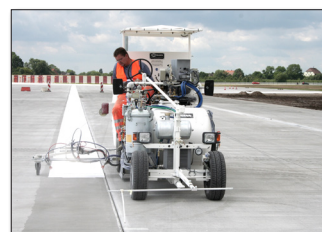
H26 in Saint Petersburg/Russia cu sistem de aplicare airspray mono-component precum si sistem aplicare Airless bi-component 98:2, cu rezervor presurizat 460 litri pentru aplicare cu un pistol respectiv marcator pentru taxi cu bi-component
