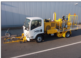
H36-800P in Hong Kong/China cu sistem de aplicare airless mono-component cu marcator aeroportuar 90 cm latime de lucru compus din 4 pistoale de vopsea si microbule, rezervoare presurizate 1 x 385 l si 2 x 220 l (diviate)
