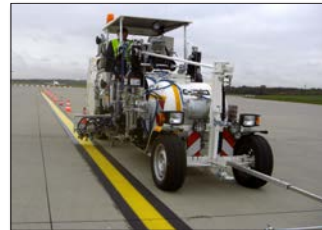
H36-800P in Hongkong/China mit 1K-Kaltfarben Airless System für den Einsatz mit 90 cm Breitstrichmarkeur mit 4 Farbpistolen und Perlpistolen, 1 x 385 ltr und 2 x 220 ltr (geteilt) Druckbehälter
