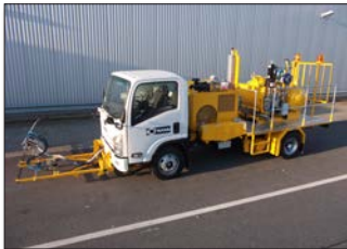
H36-800P in Hongkong/China mit 1K-Kaltfarben Airless System für den Einsatz mit 90 cm Breitstrichmarkeur mit 4 Farbpistolen und Perlpistolen, 1 x 385 ltr und 2 x 220 ltr (geteilt) Druckbehälter
