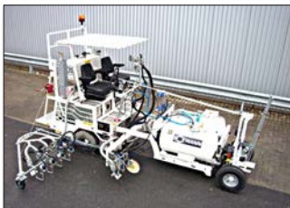
H18 bei Royal Air Force/UK mit 1K Kaltfarben Airless System (zwei Pumpen) für den Einsatz mit 90 cm Breitstrichmarkeur mit 4 Farb- und Perlpistolen sowie 3 Farb- und Perlpistolen für „taxiways“ in schwarz/gelb/schwarz, 2 x 225 ltr Druckbehälter
